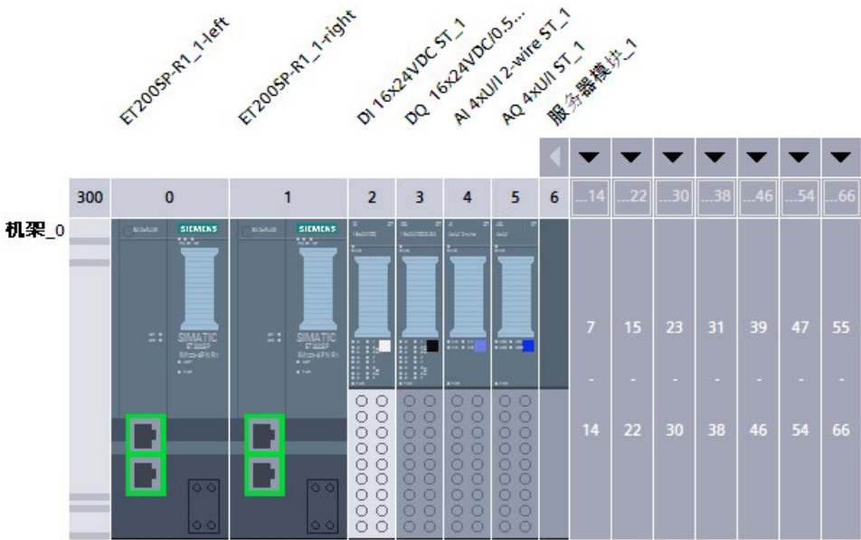
图 8-9 ET 200SP IM 155-6 PN R1 已创建，模块已分配
